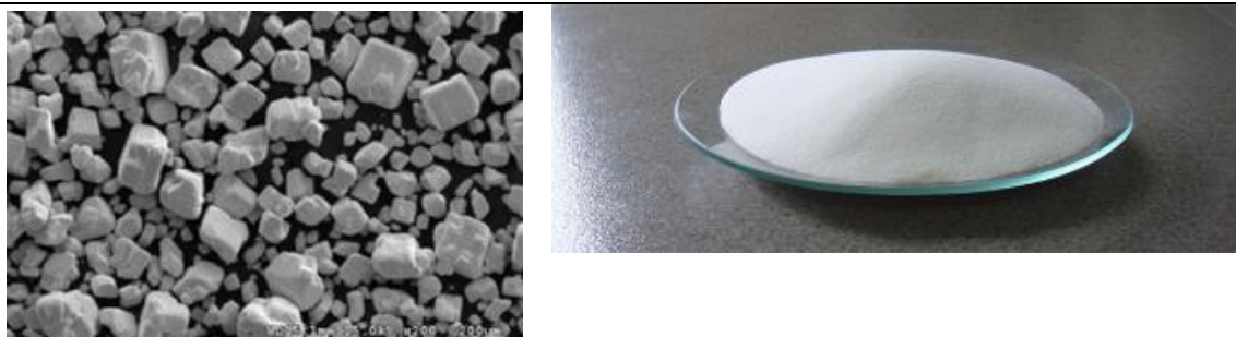
Obrázek 3-1 Prášek para-wolframu amonného. Levá část obrázku snímek pořízený řádkovacím elektronovým mikroskopem. Pravá část obrázku makrosnímek prášku zachycující jeho barevný odstín[1; 5]
