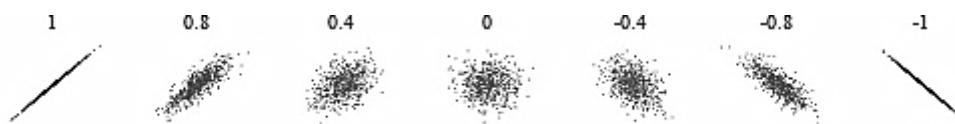
Obrázek 27 Příklady grafického zobrazení naměřených dat na bodovém grafu a příslušné koeficienty korelace 1 .
