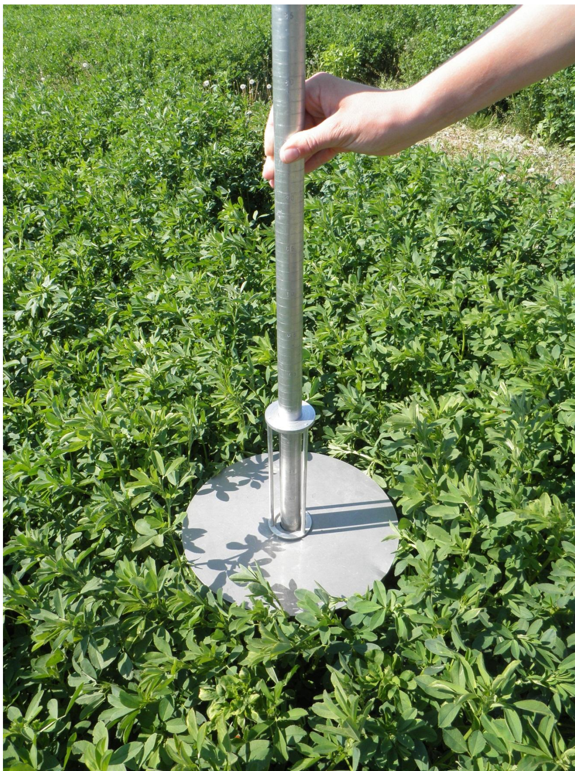
Obr. č. 1 Měření stlačené výšky pomocí RPM (Ruzyně, 2013)
