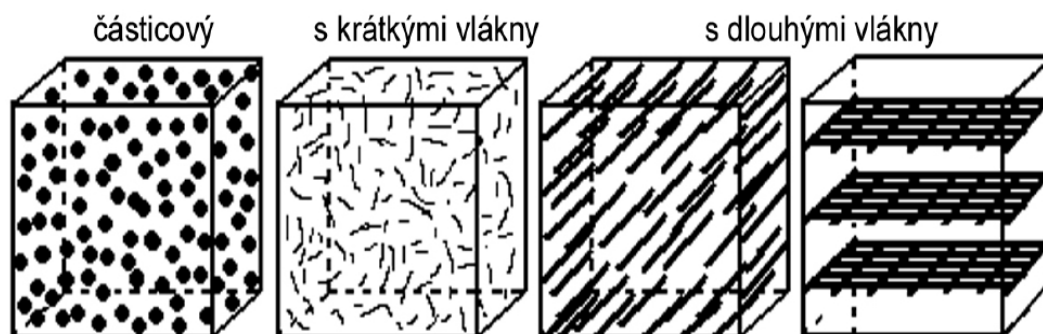
Obr.2: Rozdělení kompozitních materiálů podle geometrického tvaru výztuže [9]
