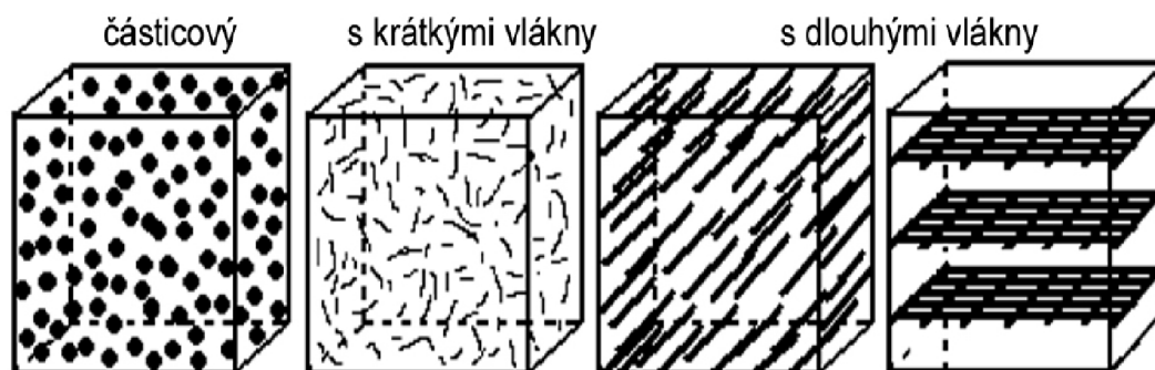
Obr.2: Rozdělení kompozitních materiálů podle geometrického tvaru výztuže [9]
