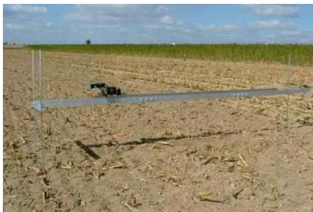
Obr. 5 Záznam příčného profilu povrchu půdy laserovým profilografem (Mayer et al., 2004)
