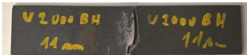
Obrázek 64 Celkový lom na vzorku namáhaný na tříbodový ohyb v klimatické komoře s BH
