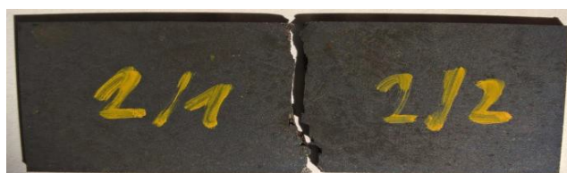
Obrázek 61 Celkový lom na vzorku namáhaný na tříbodový ohyb v klimatické komoře bez BH
