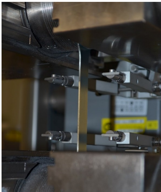
Obrázek 45 Zkušební vzorek po elektrolytickém pokovení zinkem (se zvýšeným obsahem vodíku ve struktuře) při jednoosé zkoušce tahem
