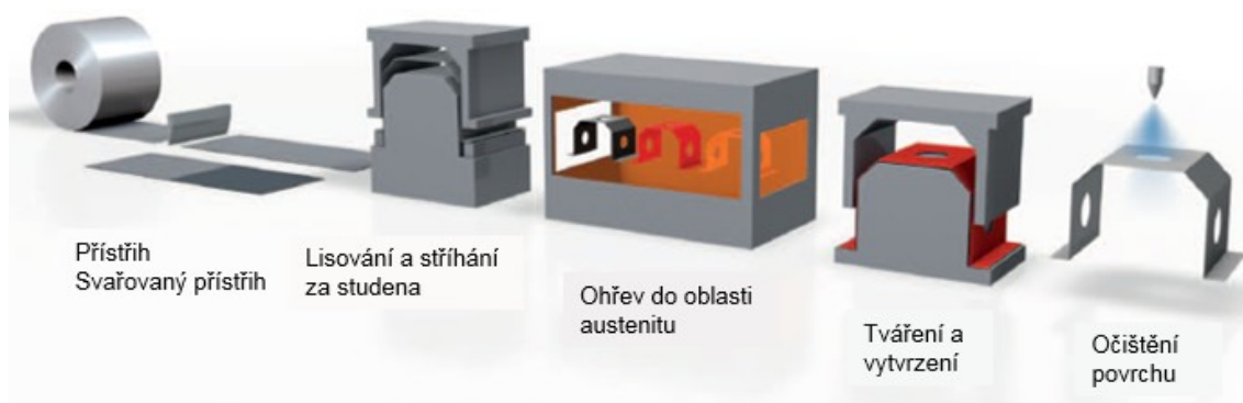
Obrázek 6 Nepřímý proces technologického postupu lisování s následným kalením v nástroji [7]
