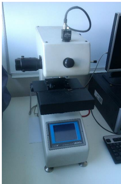
Obr. 24: Mikrotvrdoměr Leco použitý pro tuto práci.
