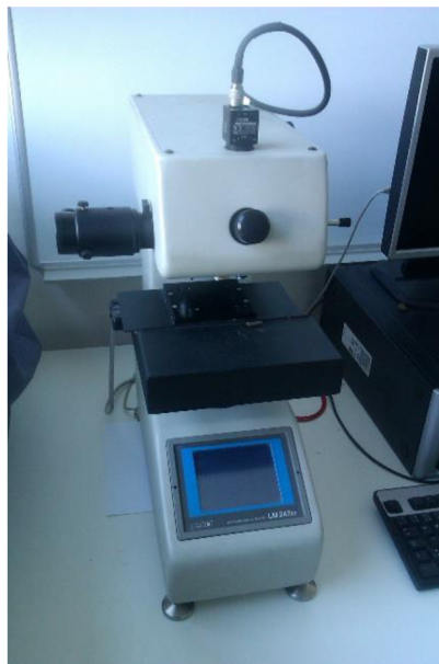
Obr. 24: Mikrotvrdoměr Leco použitý pro tuto práci.
