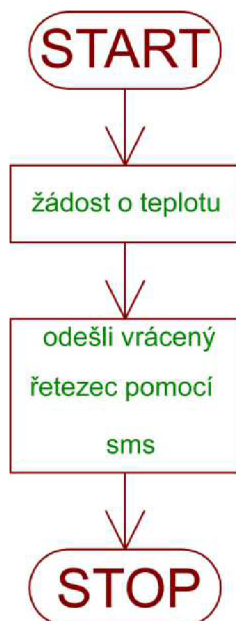
Obr. 6.8: Vývojový algoritmus podprogram gsm_temp
