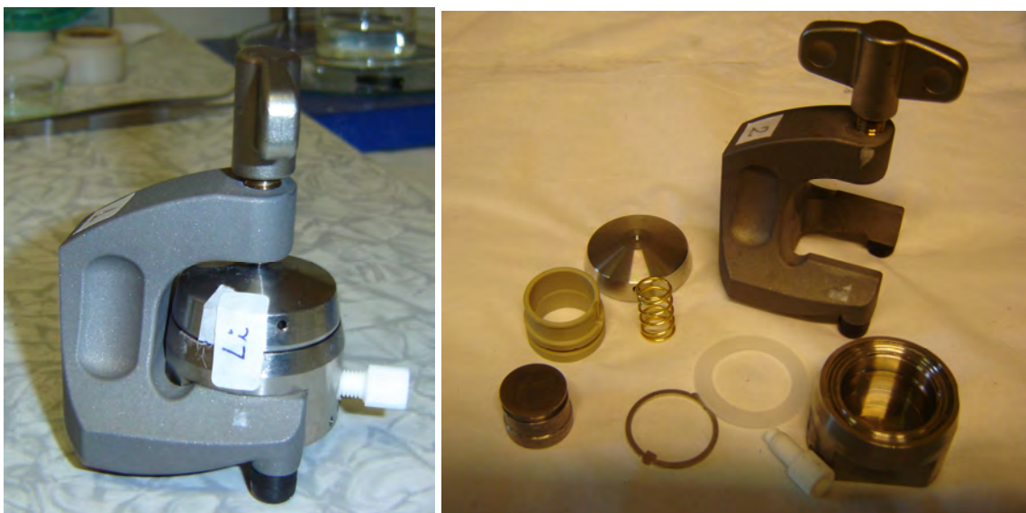
Obr. 12: Vodivostní cela ve složeném a rozloženém stavu
