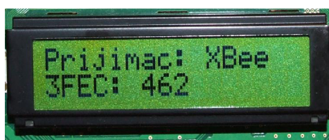
Obr. 8.17: FEC ( Frame Error Counter ) Počet chybných rámců pro a) ZigBee b) XBee
