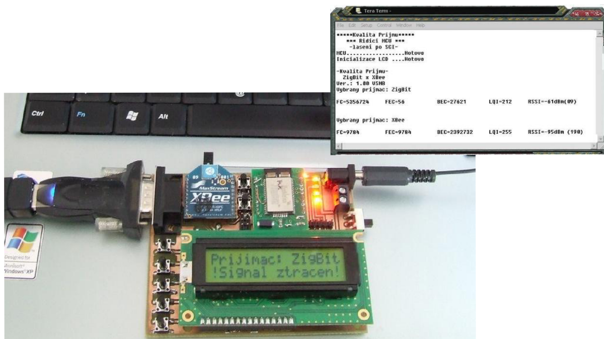
Obr. 9.2: Výsledek 17-ti hodinového praktického testu
