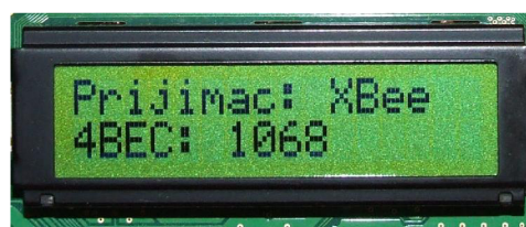
Obr. 8.18: BEC ( Bit Error Counter ) Počet chybných bitů v rámcích pro a) ZigBee b) XBee
