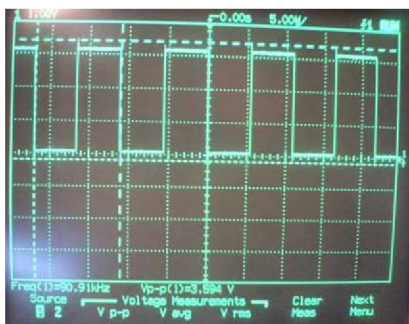
Obr. 8.8: Změřená frekvence na sestaveném generátoru v přijímacím zařízení
