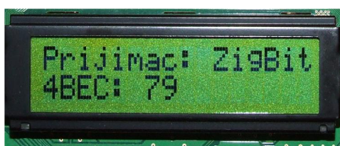
Obr. 8.18: BEC ( Bit Error Counter ) Počet chybných bitů v rámcích pro a) ZigBee b) XBee
