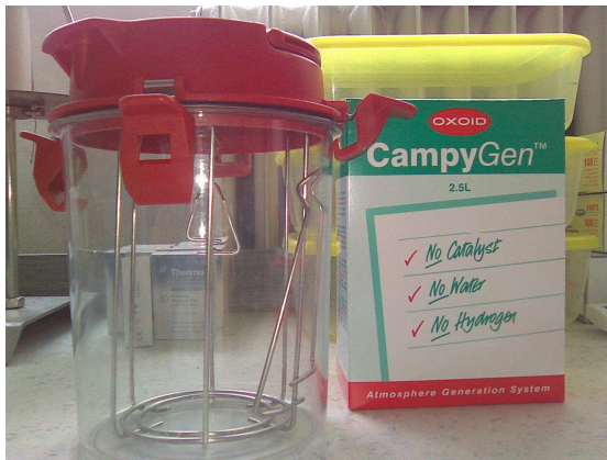
Obr. 13 Nádoba k uchování Karmali agaru ve zvláštní atmosféře v anaerostatu s vyvíječem – Campygen. Pro kultivaci C. jejuni . Zdroj: vlastní foto
