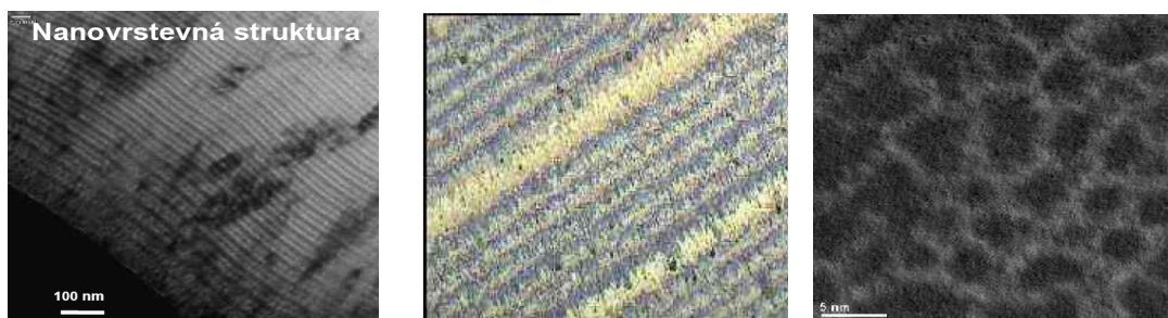
Obr. 6.9 Nanostrukturovaná, sendvičová a nanokompozitní vrstva 10
