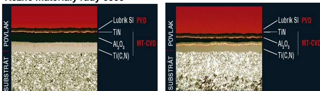
Obr. 9.6 Mikrostruktura soustružnických materiálů 6605 a 6615 73
