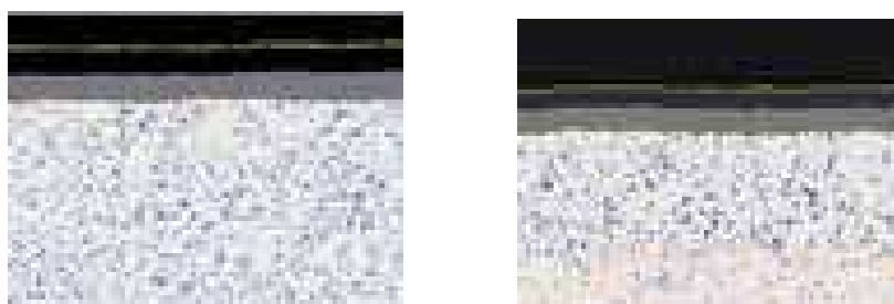
Obr. 9.19 Struktura řezných materiálů TK1000 a TK2000 75
