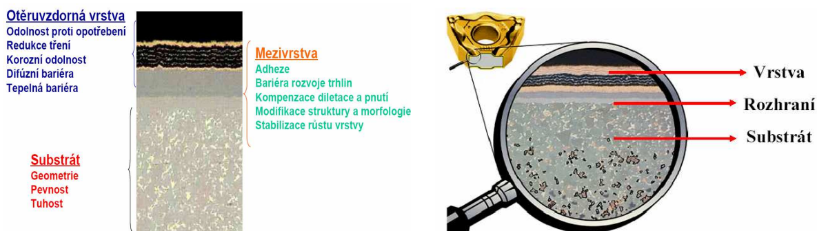
Obr. 6.1 Systém tenká vrstva - substrát a schematický řez povlakované VBD 10
