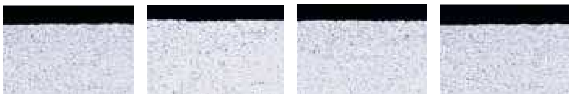
Obr. 9.21 Struktura nepovlakovaných slinutých karbidů 890, 883, HX a KX 75
