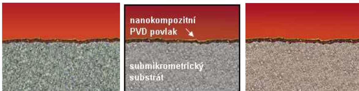
Obr. 9.5 Struktura soustružnických materiálů 8016, 8030 a 8040 72
