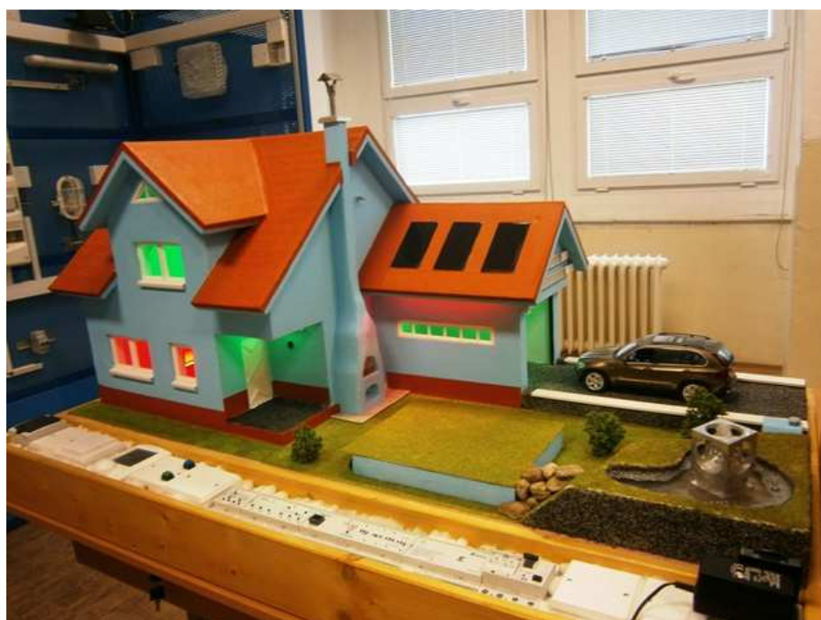
Obr. 7 Domeček svítí různými barvami, funkční alarm, snímání venkovní i vnitřní teploty, regulace teploty, funkční fontánka s vodou, ovládání garážových vrat, funkční fotovoltaické panely, ovládání přes PC, nebo manuální
