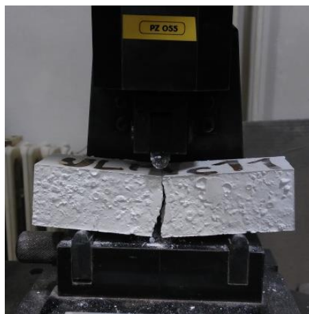
Obr. 15 – Zkouška v ohybu zkušební vzorku
