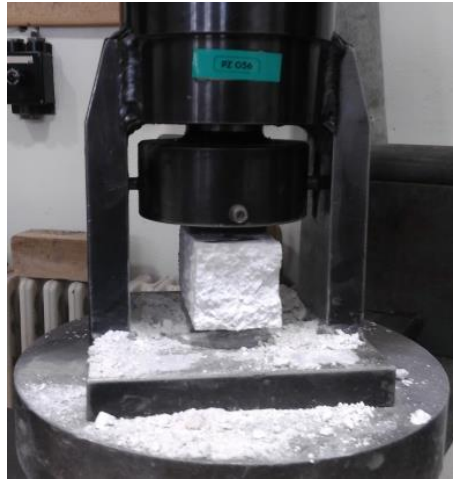
Obr. 14 – Zkouška v tlaku zkušební vzorku
