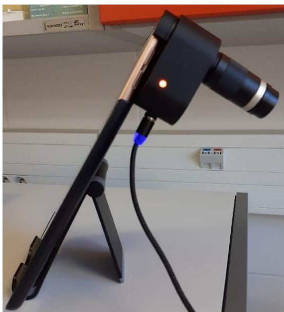
Obrázek 9 a 10: Přístroj mCASA s vyhřívanou čočkou pomocí USB kabelu (Archiv autora)
