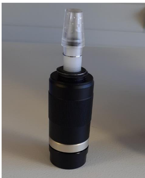
Obrázek 9 a 10: Přístroj mCASA s vyhřívanou čočkou pomocí USB kabelu (Archiv autora)
