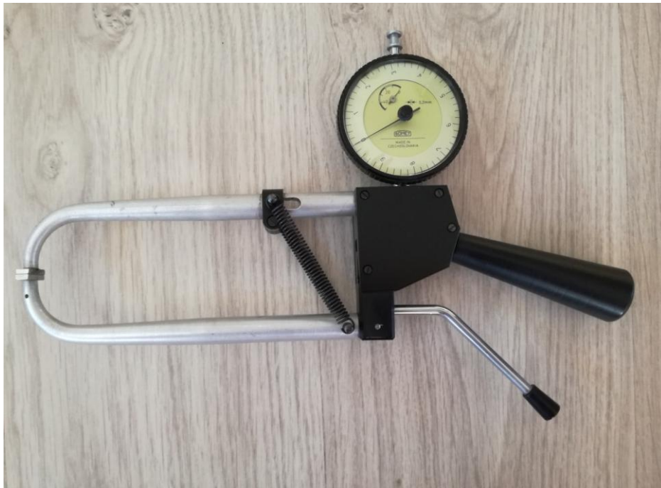
Obr. 3. Kaliper typu Harpenden použitý k měření (foto autorka práce).
