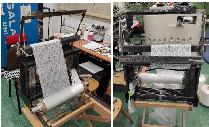
Obr. 19 a, b: Metoda pro navádění do nitěnek [18]
