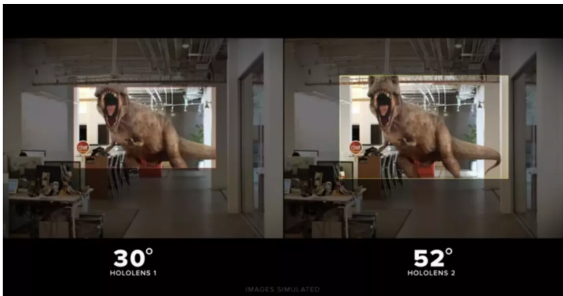
Obrázek 3.4: Porovnání rozdílných zorných polí u HoloLens 1 (vlevo) a HoloLens 2 (vpravo). 1
