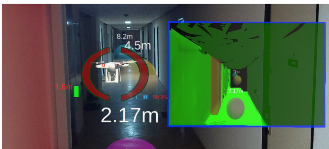
Obrázek 5.7: Při létání v bezprostřední blízkosti pilota se uživatelské rozhraní adaptuje a zobrazuje jen nutné informace. Není potřeba zobrazovat například pomocný model drona. Ten se zobrazí až při větších vzdálenostech.
