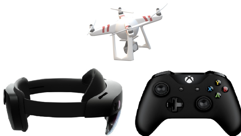
Obrázek 5.1: Komponenty navrženého systému pro vizualizaci letových dat dronu. Na- hoře: Simulovaný model dronu. Vlevo dole: Brýle Microsoft HoloLens 2. Vpravo dole: Bezdrátový ovladač pro Xbox One.
