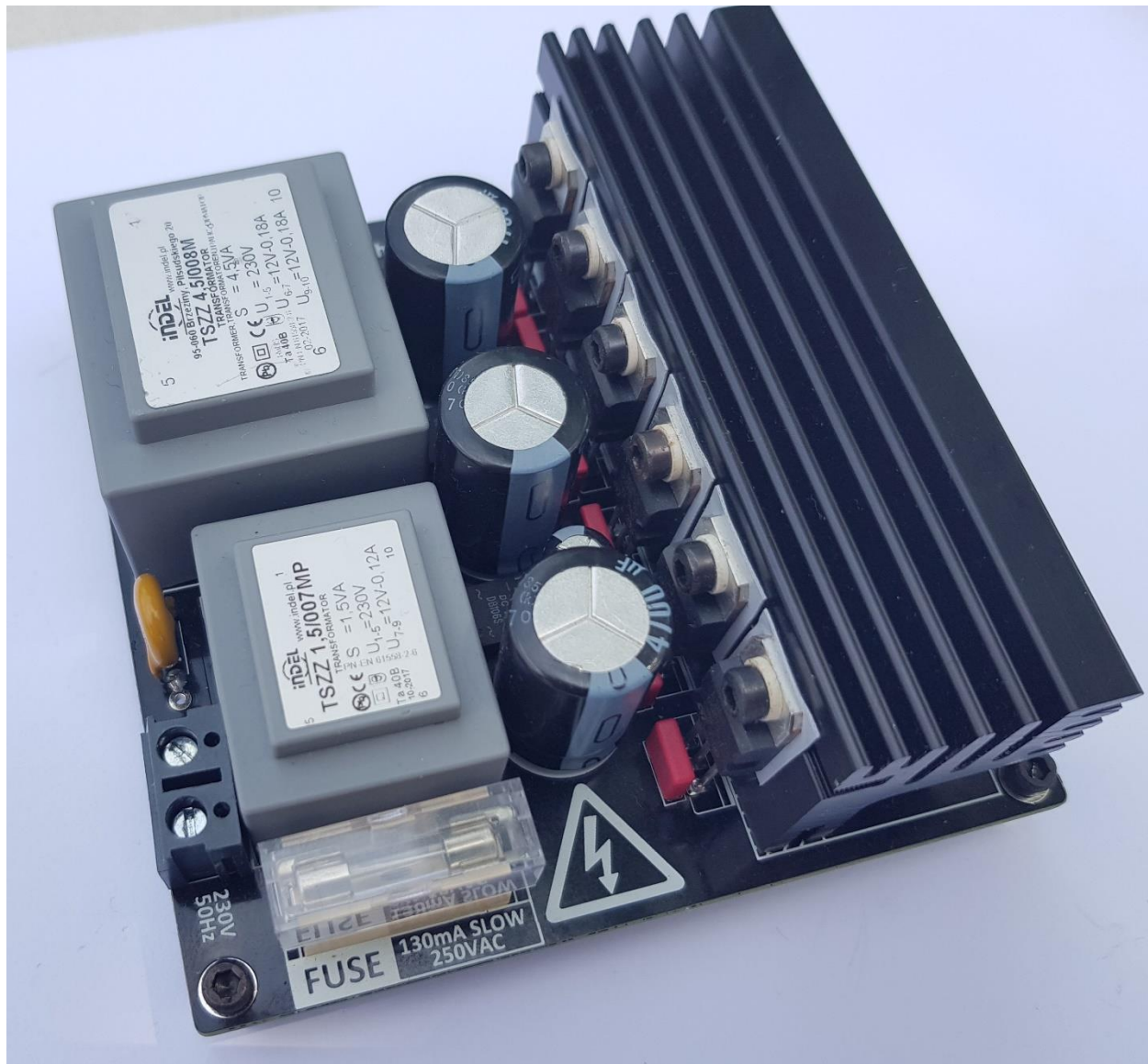
Obr. 9.15 – Fotografie sestaveného modulu zdroje
