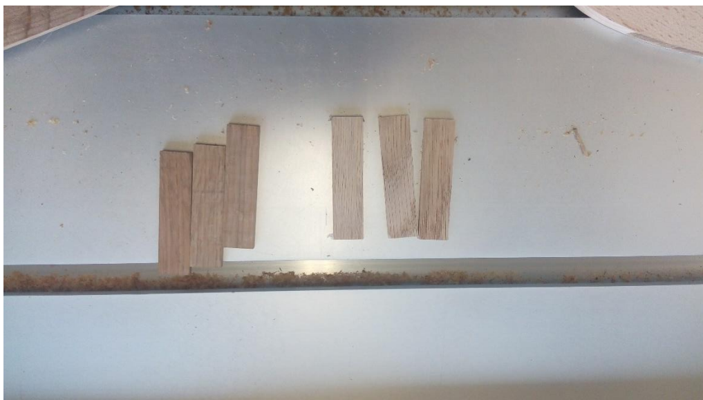
Obrázek 9: Hotové zkušební vzorky, zde ze dřeva dubu rozdělené na jádrové a bělové dřevo (zdroj: autor práce)
