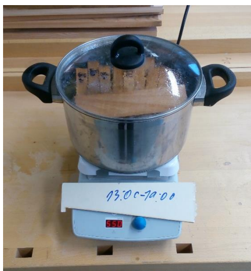
Obrázek 13: Vaření zkušebních tělísek (zdroj: autor práce)
