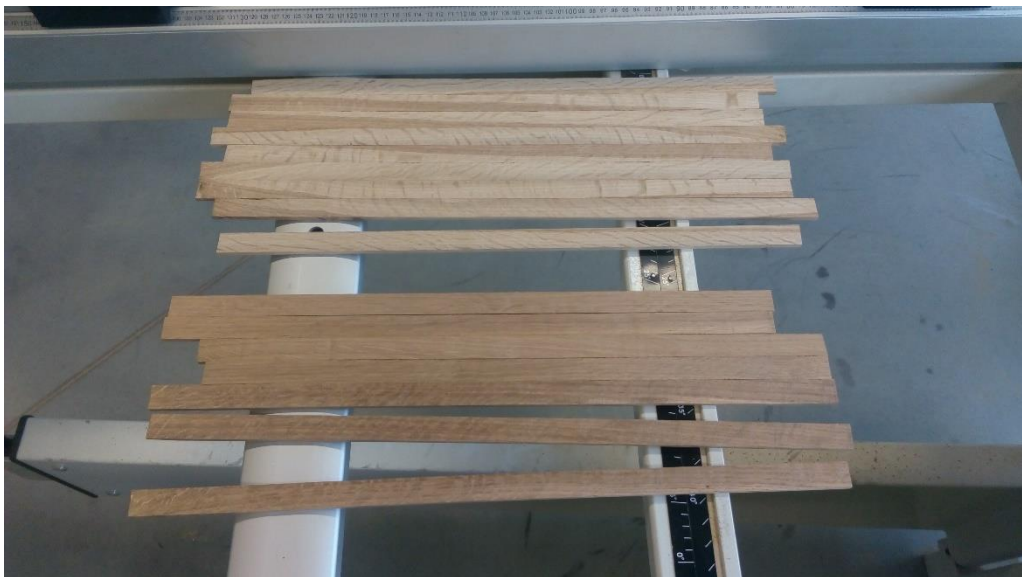
Obrázek 8: Nařezané pásy, zde ze dřeva dubu a rozdělené na jádrové a bělové dřevo (zdroj: autor práce)
