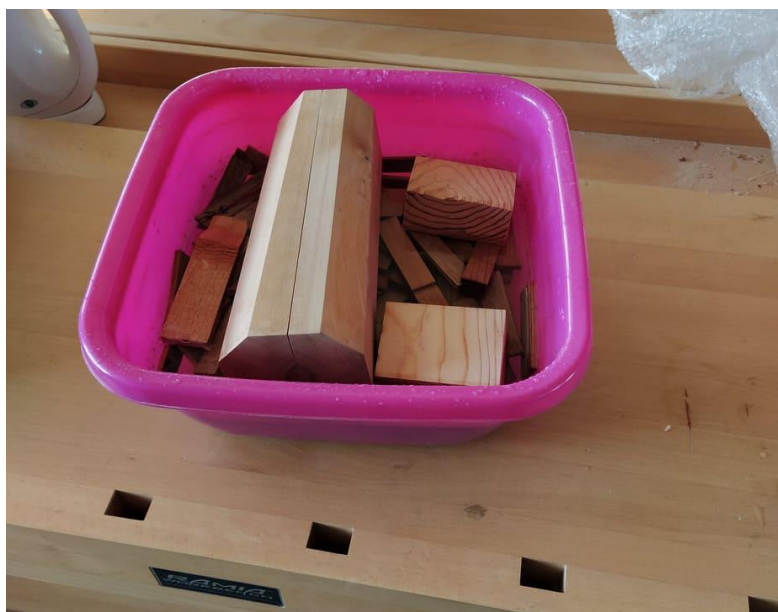
Obrázek 12: Ponoření zkušebních tělísek do vody (zdroj: autor práce)
