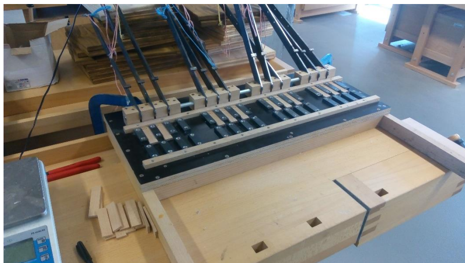
Obrázek 11: Příprava zkušebních tělísek. Zde uložení do speciálního přípravku pro výrobu zkušebních tělísek na zkoušku smykové pevnosti v tahu (zdroj: autor práce)
