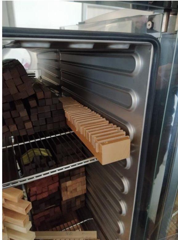
Obrázek 10: uložení zkušebních tělísek do klimatizační komory (zdroj: autor práce)
