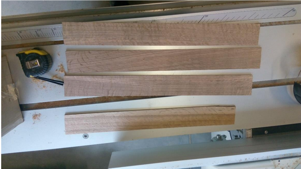
Obrázek 7: Připravené lišty k nařezání na pásy, zde z dřeva dubu (zdroj: autor práce)
