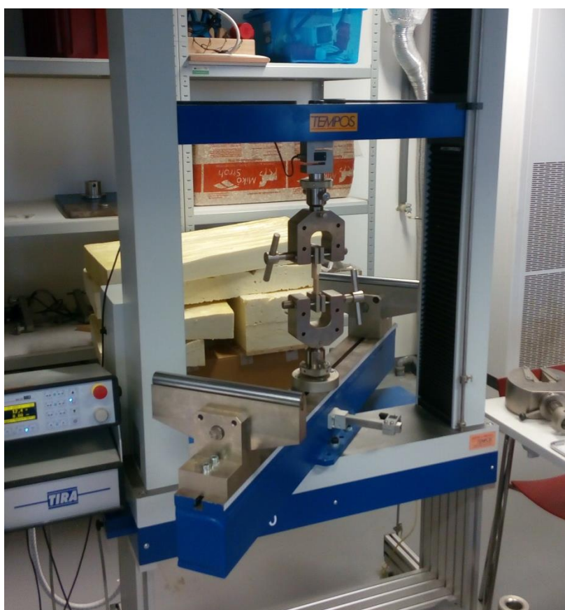
Obrázek 14: Uložení zkušebních tělísek ve zkušebním stroji (zdroj: autor práce)
