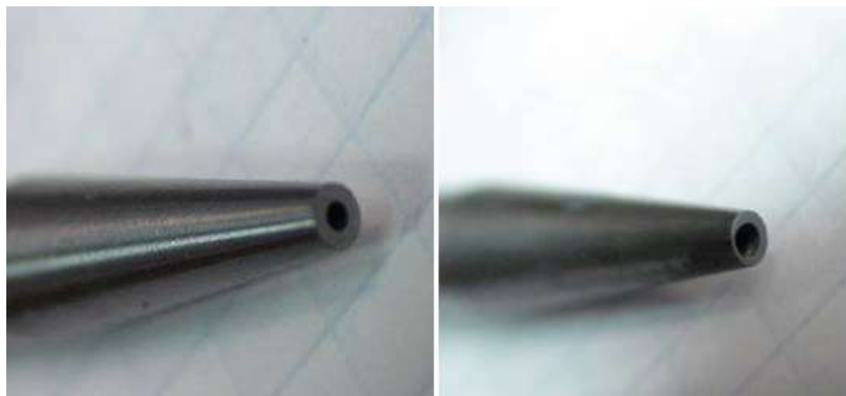
Obr. 5 Opotřebení zaostřovací trysky [16]
