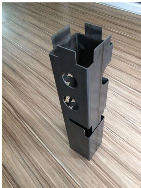
Obr. 14 Příklad obrobků řezaných 6-osým WJM [25]
