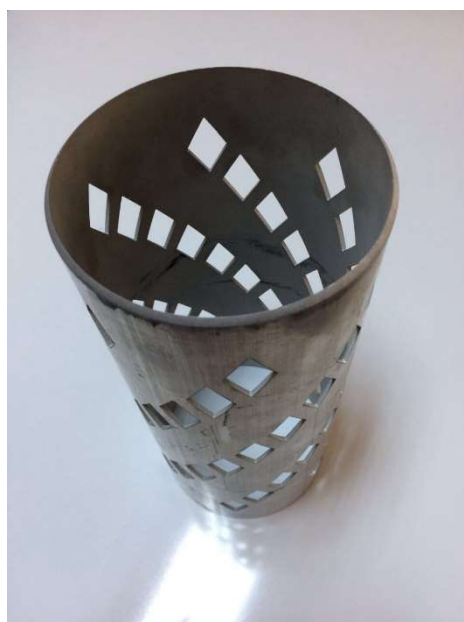
Obr. 14 Příklad obrobků řezaných 6-osým WJM [25]
