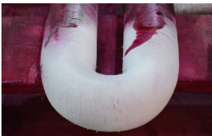
Obr. 4.13 Kapilární zkouška ohybu 0,7D [47].
