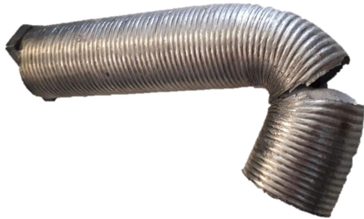
Obr. 4.25 Trhlina materiálu na vnější straně při ohybu.
