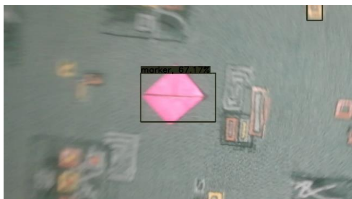
Obrázek 24 Příklad jediné falešně pozitivní detekce při použití hodnoty 0,3 jako pravděpodobnostního prahu detekce. Část koberce v pravé horní části obrázku je mylně detekována jako marker. [autor]
