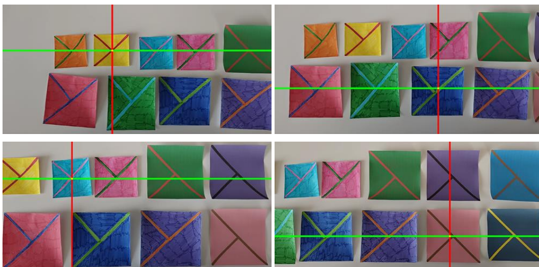
Obrázek 35 Příklady detekcí „T-křížek“ markeru s využitím algoritmu skenování řádků a sloupců. Ostatní markery jsou vždy správně ignorovány. [autor]
