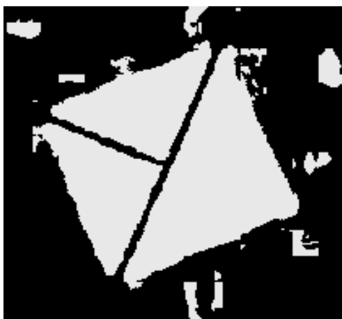
Obrázek 47 Výstup čtvrtého kroku zpracování, kdy z původního výřezu jsou zachovány pouze pixely, které mají odstín podobný odstínu detekovaného markeru (tedy dominantního odstínu v daném výřezu) [autor]
