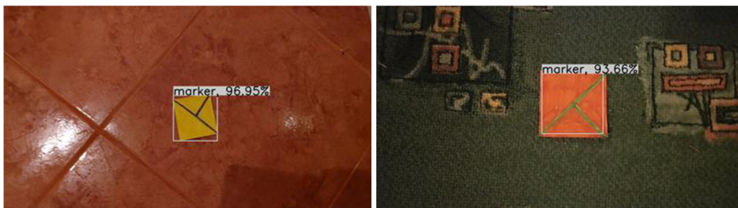
Obrázek 26 Příklady detekcí neuronovou sítí pro ručně kreslené markery snímané v interiéru za umělého osvětlení [autor]
