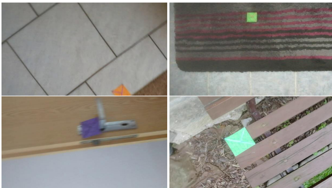
Obrázek 23 Příklady všech čtyř falešně negativních případů při použití hodnoty 0,3 jako pravděpodobnostního prahu detekce. Při použití prahu o hodnotě 0,2 jsou markery v horních dvou obrázcích korektně detekovány. [autor]
