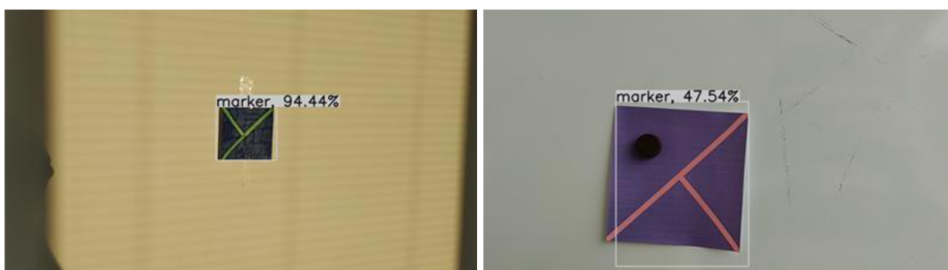
Obrázek 29 Příklady detekcí neuronovou sítí. Vlevo ručně kreslený marker snímaný v interiéru, jehož barva je tmavě modrá, avšak pod přímým slunečním světlem je téměř černá. Vpravo tištěný marker, který je na magnetickou tabuli přichycen magnetem. [autor]
