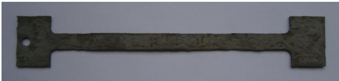
Obr. 29 Vzorek po odstranění korozních zplodin (autor)
