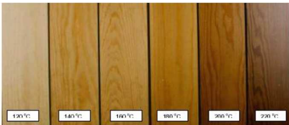
Obr. 24 Barva tepelně zpracované borovice při teplotách od 120° do 220° C ve 20°C intervalech.
