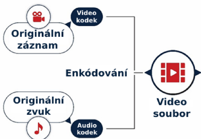
Schéma 1 Kodek a kódování Zdroj: vlastní překlad podle (Peng, c2023)
