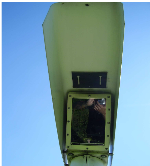
Obr. 7. Ochranné sklo vysílače s odporový vytápěním a kryt s plotnou pro filtr
