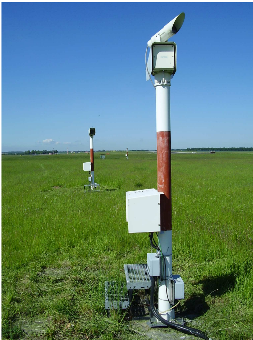
Obr. 5. Vysílač transmisometru MITRAS se dvěma základnami a snímačem jasu pozadí
