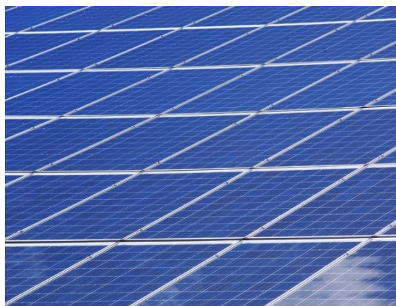
Obrázek 21 FV panel na bázi polykrystalického křemíku
