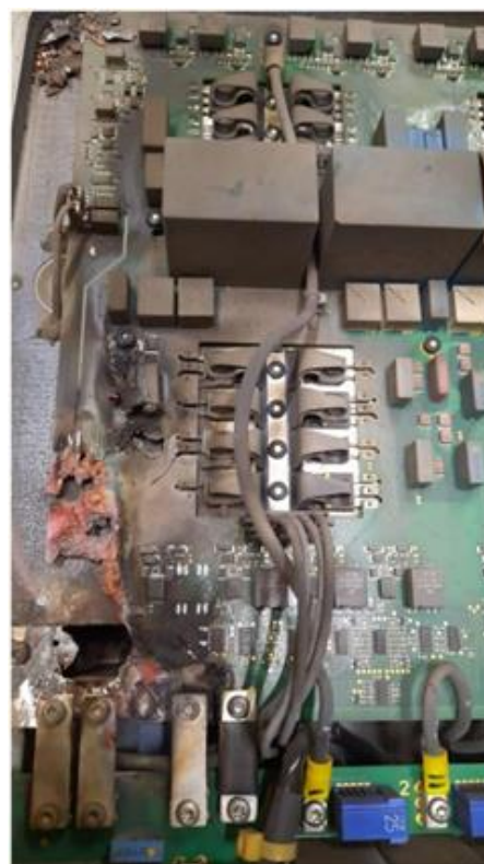
Obrázek 42 Zničený měnič SMA
