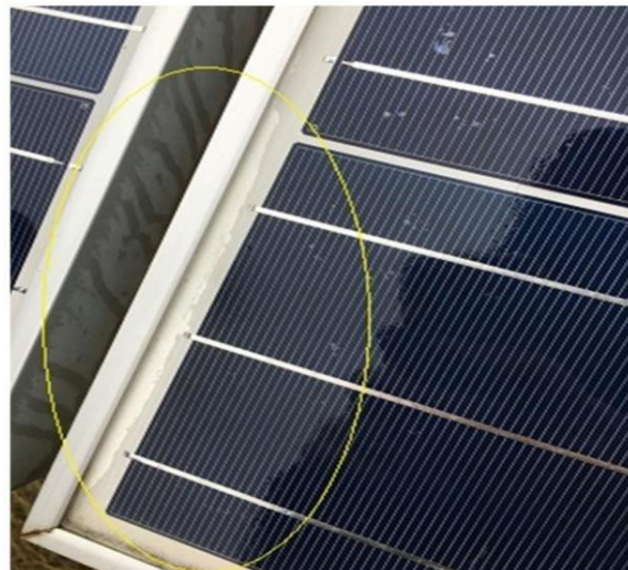
Obrázek 35 Ukázka delaminace hran
