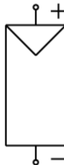
Obrázek 19 Schematická značka fotovoltaického panelu
