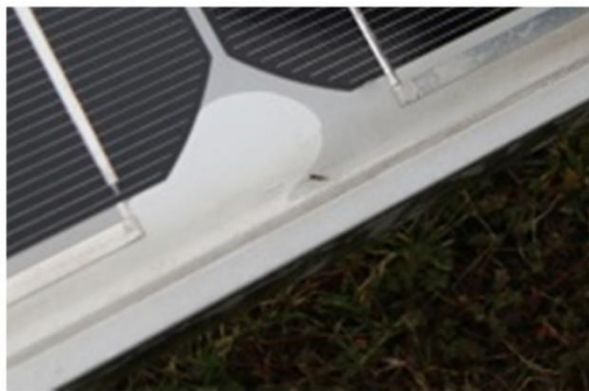
Obrázek 34 Ukázka delaminace hran 4. typu
