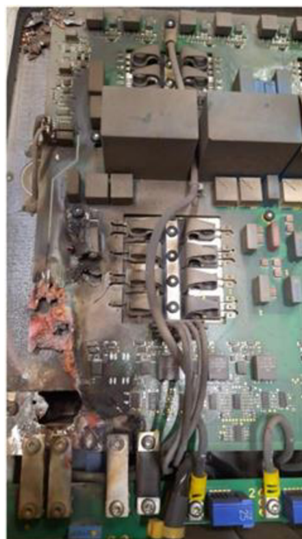
Obrázek 42 Zničený měnič SMA
