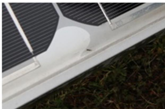
Obrázek 34 Ukázka delaminace hran 4. typu
