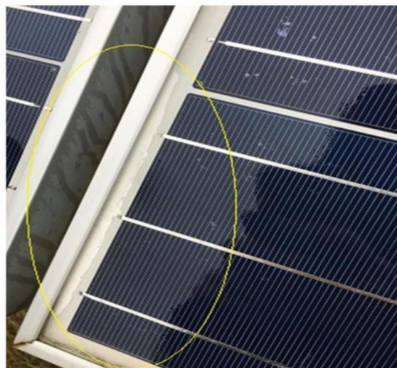
Obrázek 35 Ukázka delaminace hran
