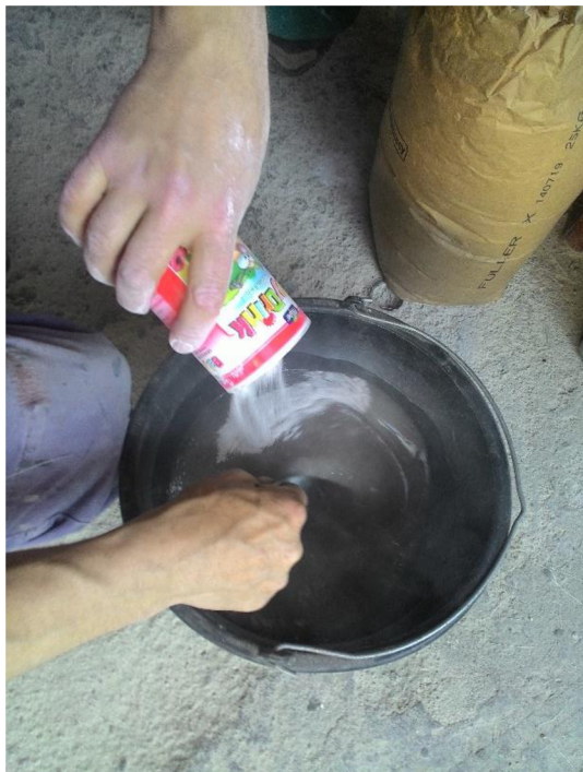
Obr. 3.27 Smíchání kompozice s plnidlem.
