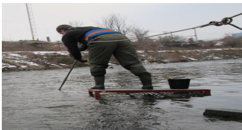
Obrázek 4: Odběr sedimentů ze vzorkovací plošiny (Dekonta,2017)
