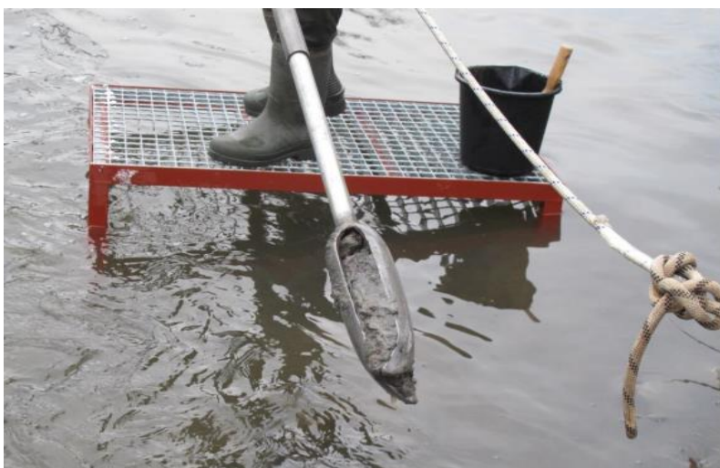
Obrázek 5: Ruční vrtací souprava (Dekonta, 2017)
