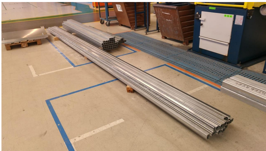
Obr. 8.7: Nevhodné uložení vstupního materiálu
