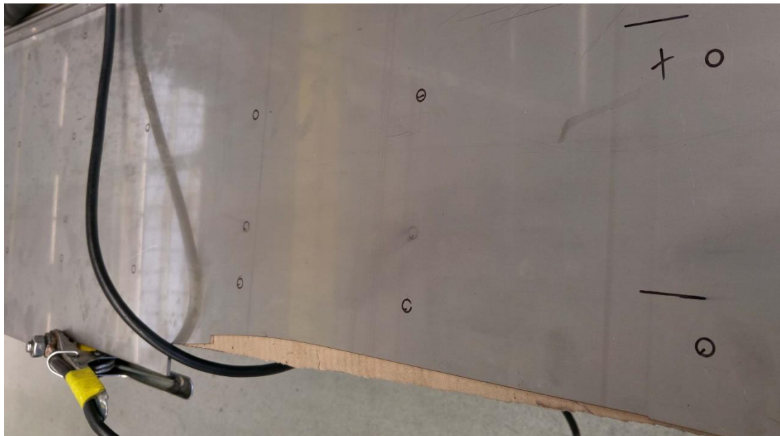
Obr. 5.9: Plech připravený k navařování svorníků
