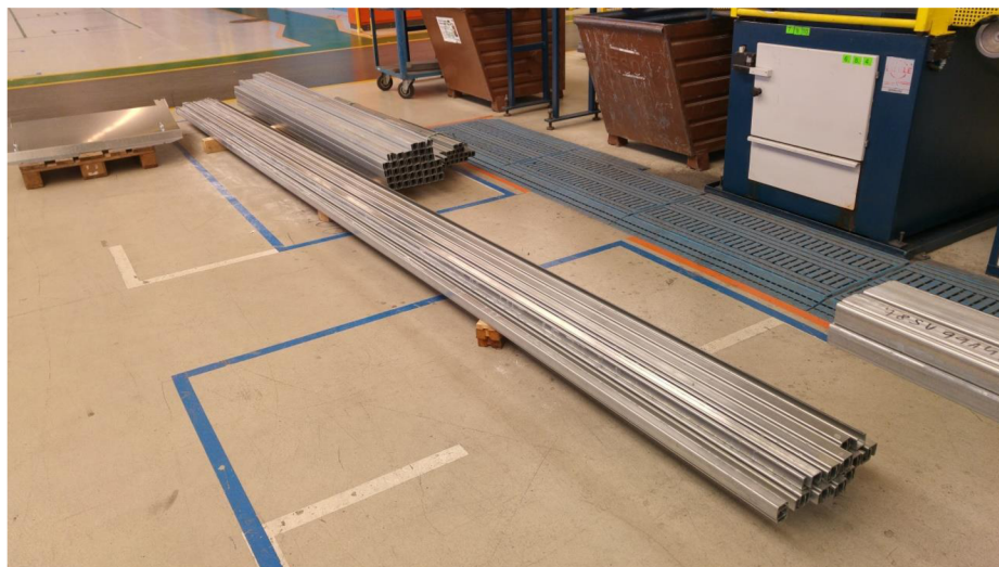
Obr. 8.7: Nevhodné uložení vstupního materiálu
