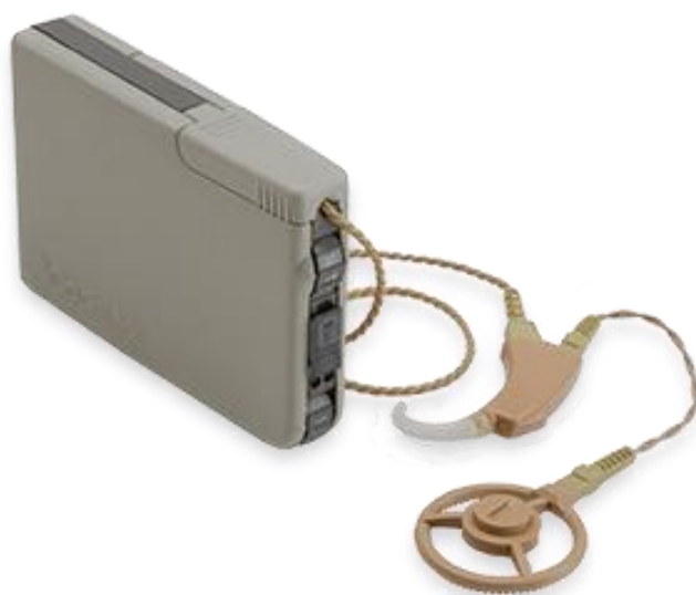
Obrázek 3: Řečový procesor z roku 1989 MSP – Mini Speech Processor
