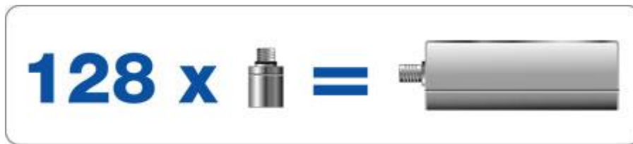
Obr. 11 Znárodnění složení phased array sondy pomocí jednoměničových sond [10].
