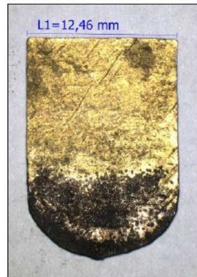
Obr. 40 Elektroda po výrobě defektu č.1.
