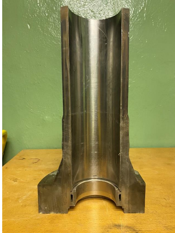
Obr. 37 Etalon vyrobený z reálného nátrubku HRK.
