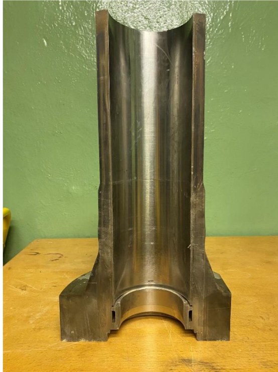
Obr. 37 Etalon vyrobený z reálného nátrubku HRK.
