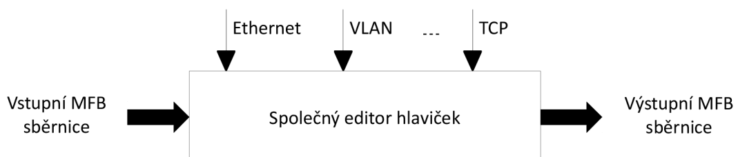
Obr. 3.3: Blokové schéma obvodu s jedním společným editorem.
