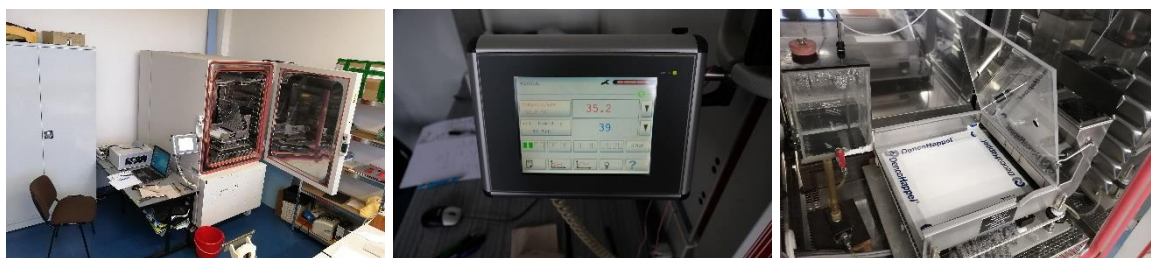
Obrázek 22: Příklad přístroje SGHP uvnitř klimatizační komory s upnutým zkušebním vzorkem
