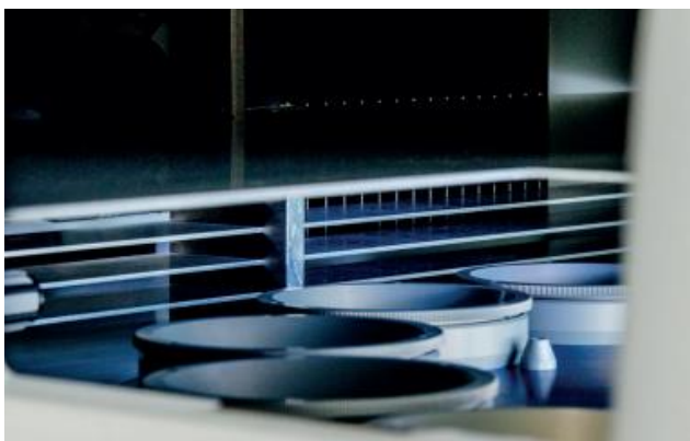
Obrázek 2: Misky uvnitř přístroje CupMaster [4]
