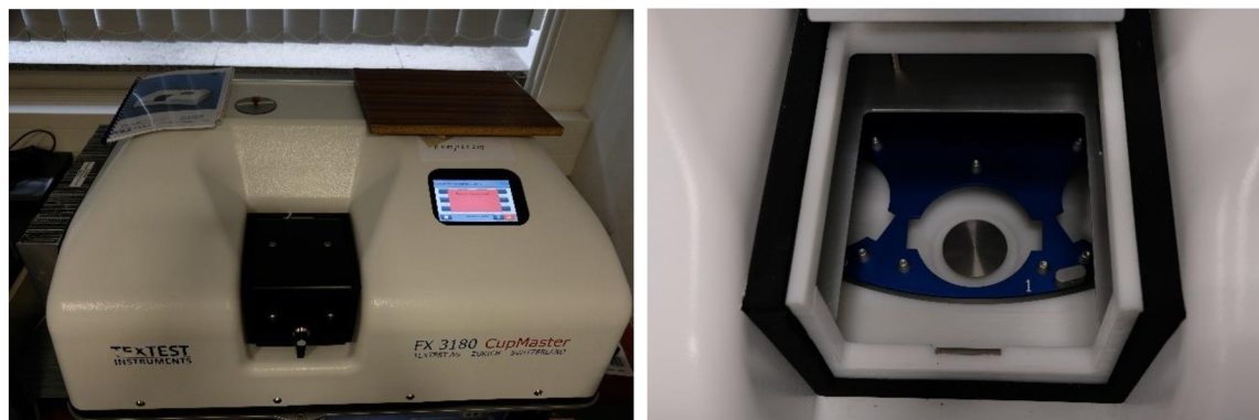
Obrázek 17: přístroj FX3180 CupMaster, v detailu prostor pro misky s váhou
