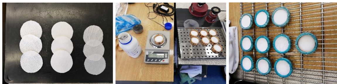
Obrázek 18: Příprava vzorků a vážení chloridu draselného do misek pro metodu A-1
