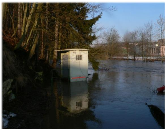
Obr. 17: Limnigrafická stanice s kombinovanou vodočetnou latí při povodni. Vodočet Světlá nad Sázavou (MěÚ Světlá nad Sázavou 2006)
