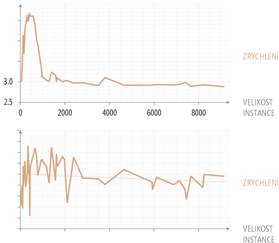
Obrázek 8.5: Zrychlení dosažené zapojením konceptu skupin. V horní části je znázorněna situace na makro úrovni, kde zařízení u menších instancí dokáže využít hardwarově řízenou L1 cache. Ve spodní části je vidět stabilnější charakter zrychlení na mikro úrovni.
