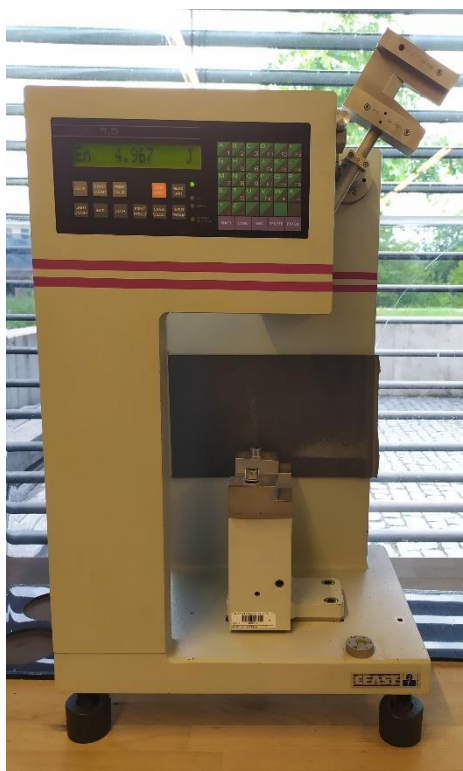
Obr. 3.11 Zařízení Resil Ceast 5.5 pro testování rázové houževnatosti Charpy
