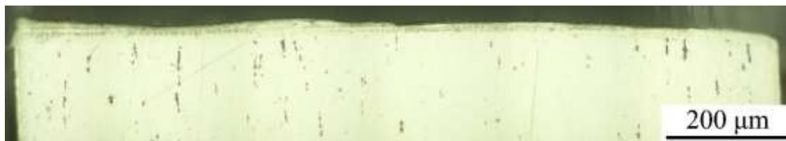
Obr. 23 Fotografie řezu při zvětšení 500x; na horní straně vzorku je vidět jemná hranice přetavené vrstvy po laserovém řezání
