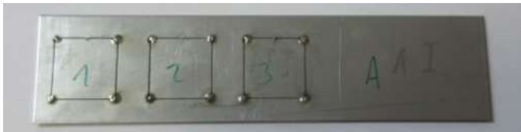
Obr. 13 Přichycení výřezů pomocí bodových svarů
