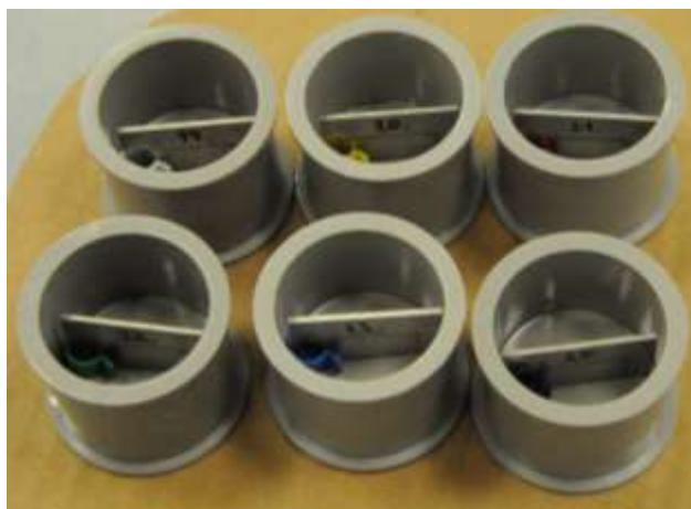
Obr. 18 Příprava vzorků k zalití
