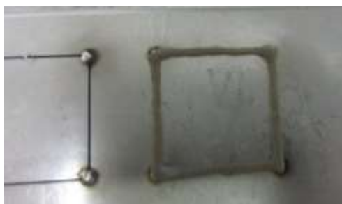
Obr. 14 Nanesení pájecí pasty
