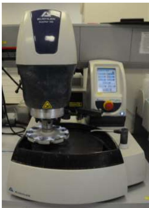
Obr. 20 Bruska a leštička BUEHLER AutoMet 300
