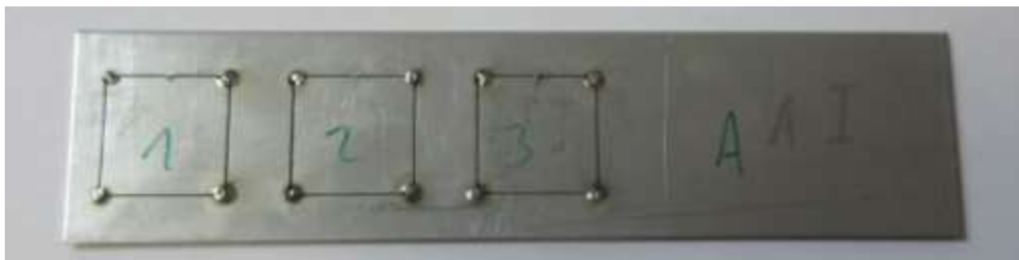
Obr. 13 Přichycení výřezů pomocí bodových svarů
