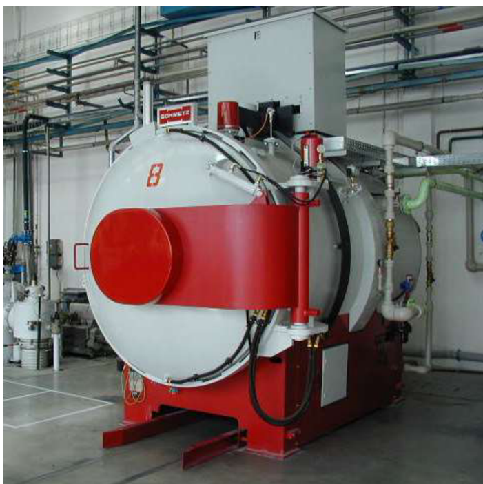
Obr. 15 Vakuová pec SCHMETZ TYP I 210/1H/2RV
