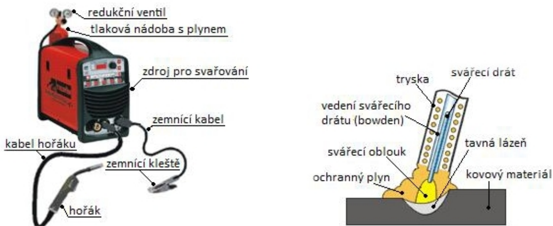
Obr. 2 Zařízení pro svařování a detail principu svařování
