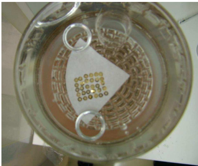
Obr. 14 Síťky ze zlata vyskládané na filtračním papíru v nálevce zalité DEMI vodou
